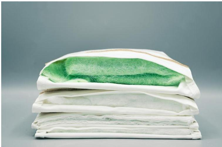
**Bild:** Verschiedene Aerogel-Vliese. Das grüne Muster ist ein Acryl/Viscose-Aerogel-Vlies, dessen Fasern aufwendig geschnitten und verarbeitet werden müssen. Die weißen Demonstratoren sind Kissen mit 25 x 25 cm mit verschiedenen hochbauschigen Versionen der biobasierten Zellulose-Aerogele der ITA-Forscher\*innen, die direkt als textile Fläche aus der Maschine kommen.
