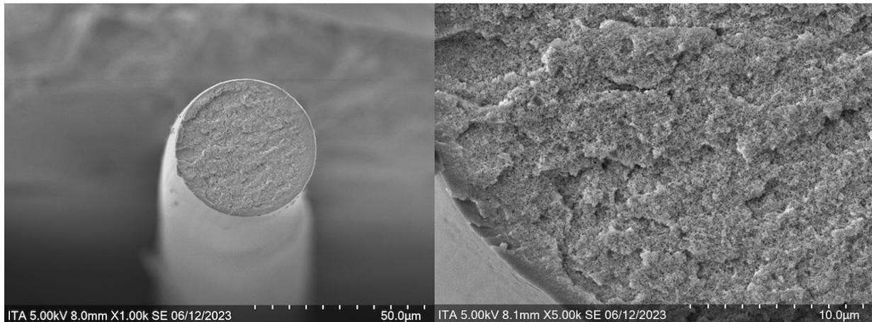
**Links:** Querschnitt einer einzelnen superisolierenden Aerogel-Faser mit ihren Millionen von Nano-Hohlräumen, 1.000-fache Vergrößerung.
